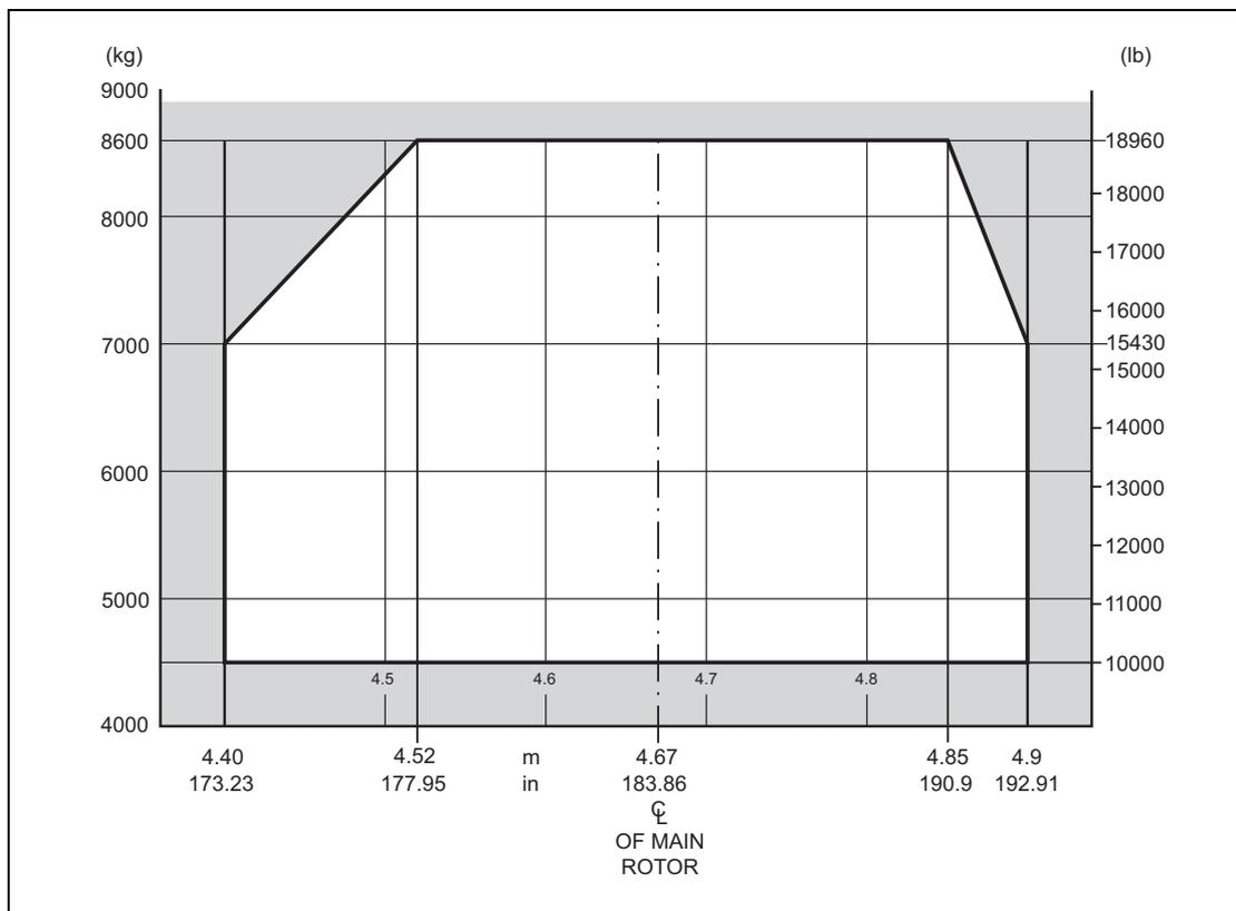
**Figure 3.3** Longitudinal CG Limits
