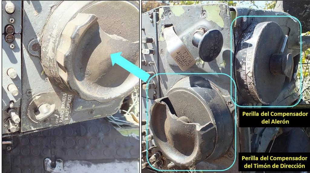
**Fotografía No. 9:** Posiciones de las perillas compensadoras de alerones y timón de dirección
