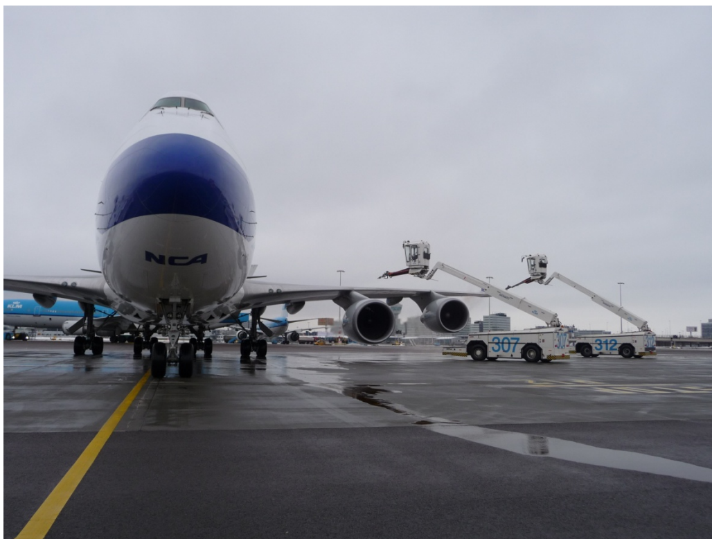
Figuur 2: Safeaero's tijdens een de-icingbehandeling, gezien vanuit het voertuig van een supervisor
